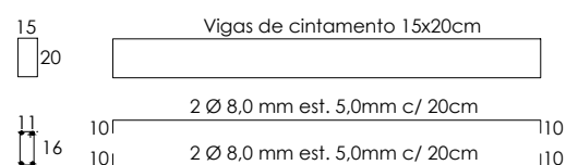
DETALHAMENTO ARMADURA VIGAS E PILARES Esc. S/ ESC
